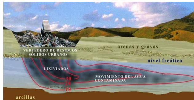
Esquema de contaminación a través del suelo por medio de lixiviados que se filtran.
